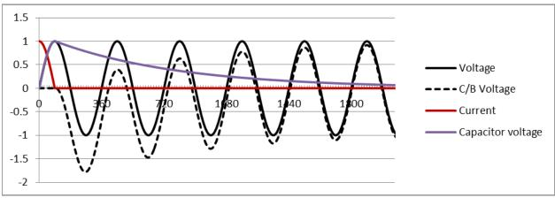
Figure 14 : Capacitor discharge
