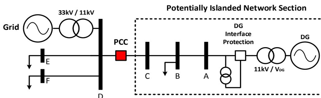
Figure 2. 11kV Test Network
